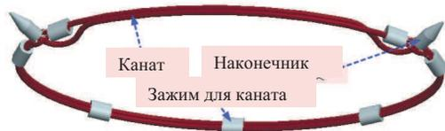
Рис. 4.14. Предохранительный трос
