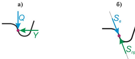
Рис. 2.12. Схема сил: а) по Надалю; б) возвращающих колесо вниз и препятствующих скольжению колеса вниз
