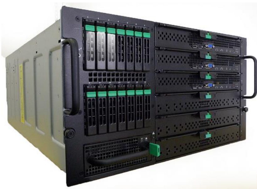
Рисунок 3.5 – Сервер Intel MFSYS25, що монтується у стійку
