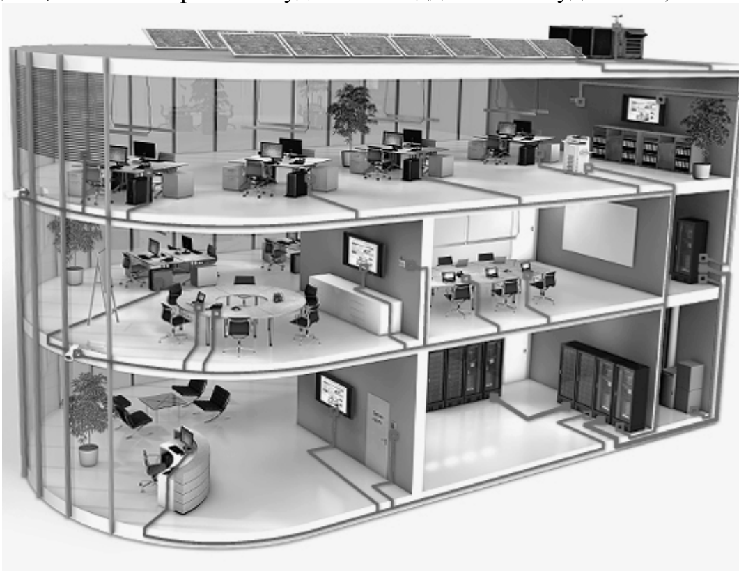
Рис. 1.3. План будівлі з кабельними з’єднаннями мережі
